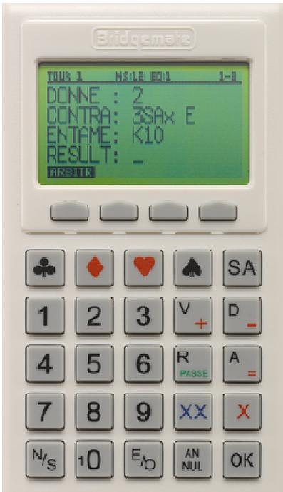
Pour activer le Bridgemate, il suffit d'appuyer sur le bouton OK. De même, la touche OK réactive, sans perte de données, l'appareil après une mise en veille automatique. L'appareil se compose d'un affichage, de 4 touches de fonction en dessous de l'affichage et d'un clavier de 25 touches.
